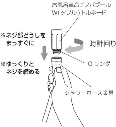
④お風呂革命ナノバブル W(ダブル)トルネードを押さえ、シャワーヘッドを右図のように時計回りに回して取り付けます。その際 Oリングが歪んではいみ出さないようにゆっくりと回してください。最後にしっかりと締めます。
