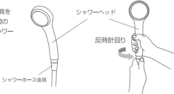
③シャワーホース金具を押さえ、お風呂革命 ナノバブル W(ダブル)トルネードを下図のように回して取り付けます。この際 Oリング (パッキン) が歪んではいみ出さないようにゆっくりと回してください。最後にしっかりと締めます。
