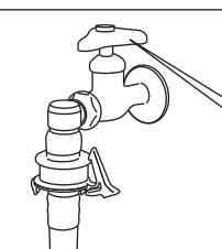
取り付け作業の前に必ず水栓を最後まで閉めたことを確認してください。水漏れの原因となります。
